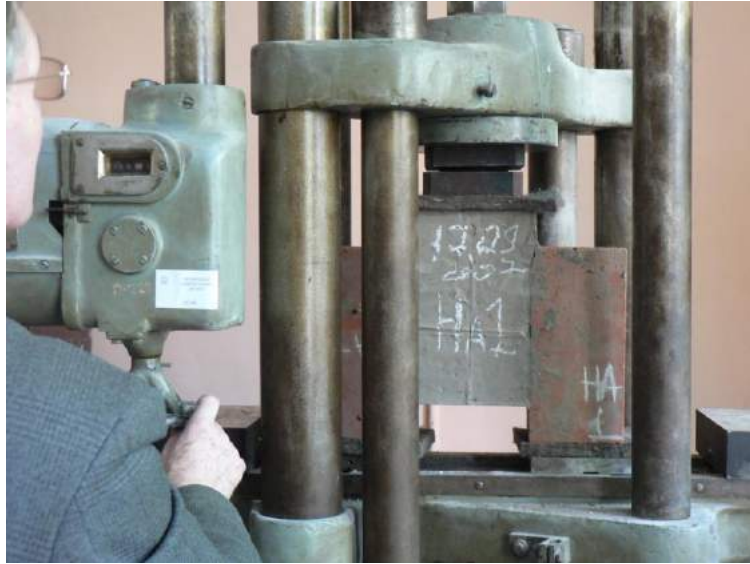
Рисунок 2.49 – Испытания межслоевого сцепления кирпичных и железобетонного слоев.
