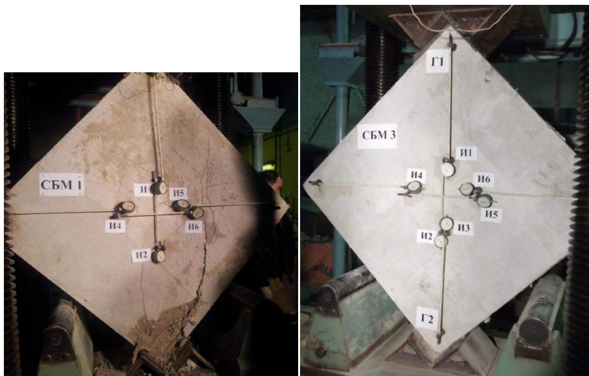
Рисунок 2.44 – Образец СБМ-1 после испытаний. Максимальная нагрузка 31 т (слева) Испытание образца СБМ-3 на перекося. Общий вид образца в прессе (справа).
