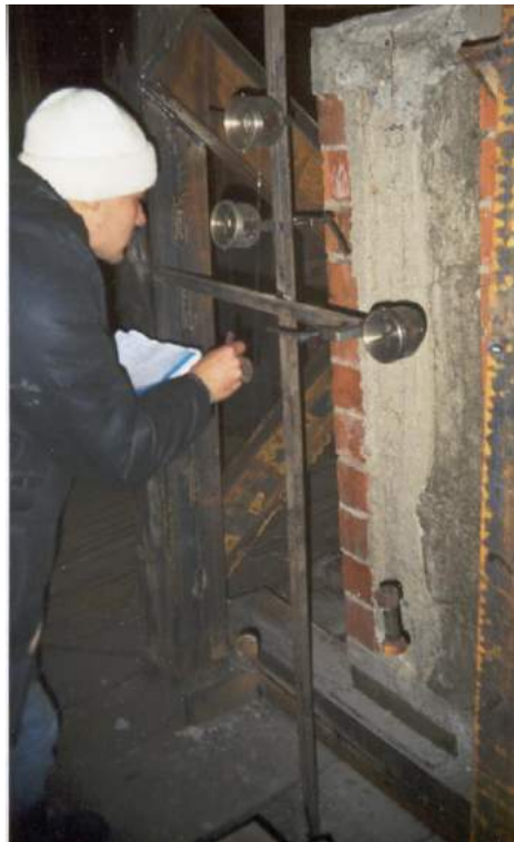
Рисунок 2.6 – Установка прогибомеров при испытании многослойных фрагментов
