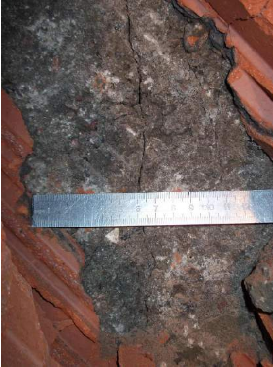
Рисунок 2.36 – Диагональная трещина внутреннего железобетонного слоя а) образец МС-1; б) образец МС-2
