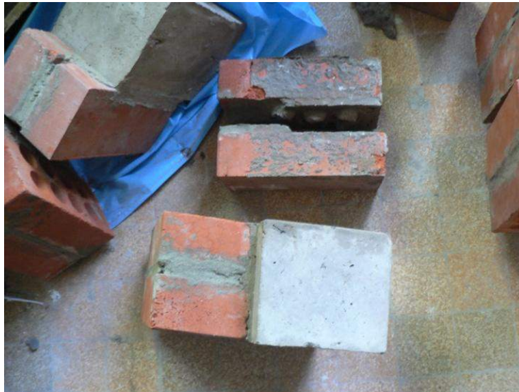
Рисунок 2.49 – Испытания межслоевого сцепления кирпичных и железобетонного слоев.
