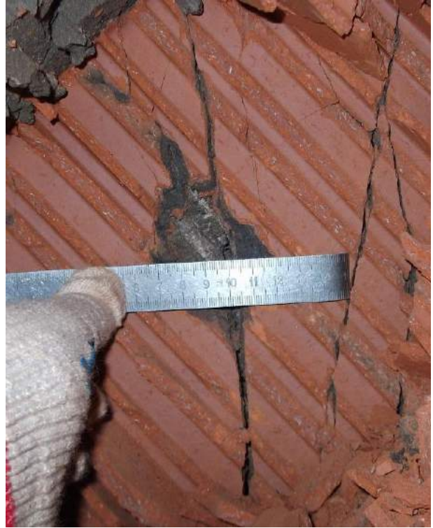
Рисунок 2.36 – Диагональная трещина внутреннего железобетонного слоя а) образец МС-1; б) образец МС-2
