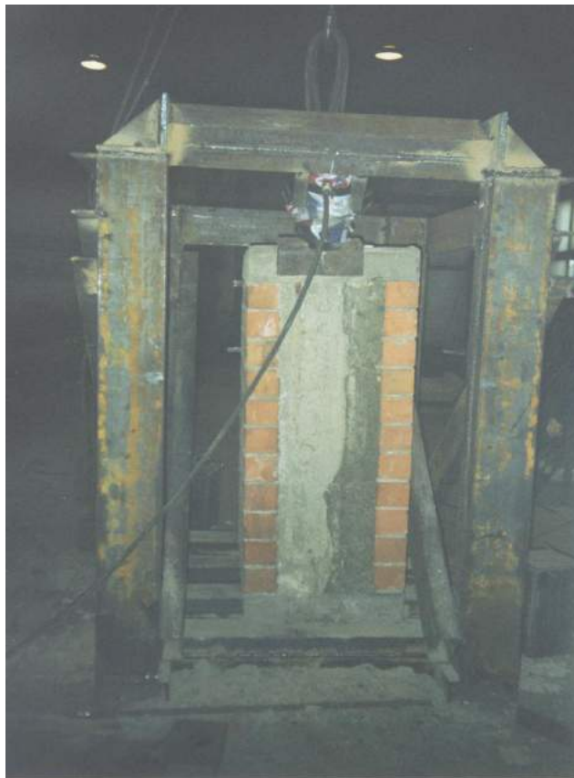
Рисунок 2.4 – Образец 4-х слойной стены на испытательном стенде
