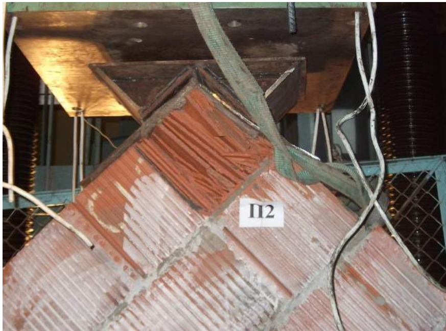
Рисунок 2.28 – Разрушение образца С1-250
