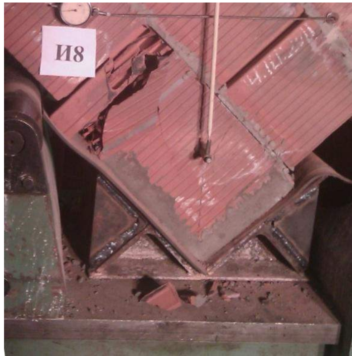
Рисунок 2.31 – Разрушение опорной зоны образца С3-250
