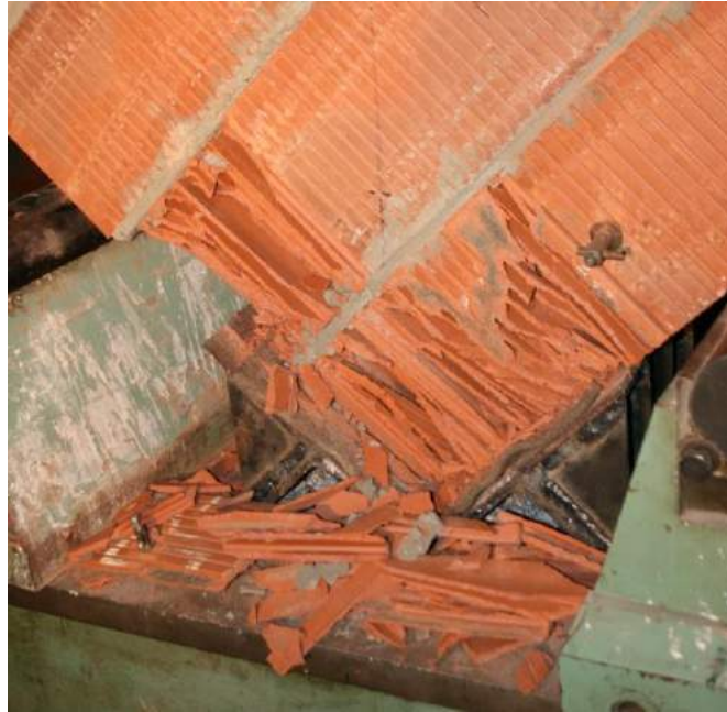
Рисунок 2.30 – Разрушение опорной зоны образца С2-250
