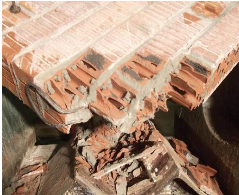
Рисунок 2.24 – Образец С2-1 после снятия с испытательной установки
