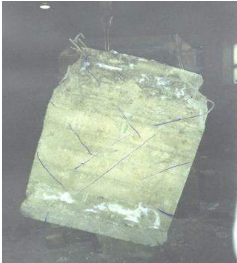
Рисунок 2.7 – Однослойный фрагмент стены после испытаний
