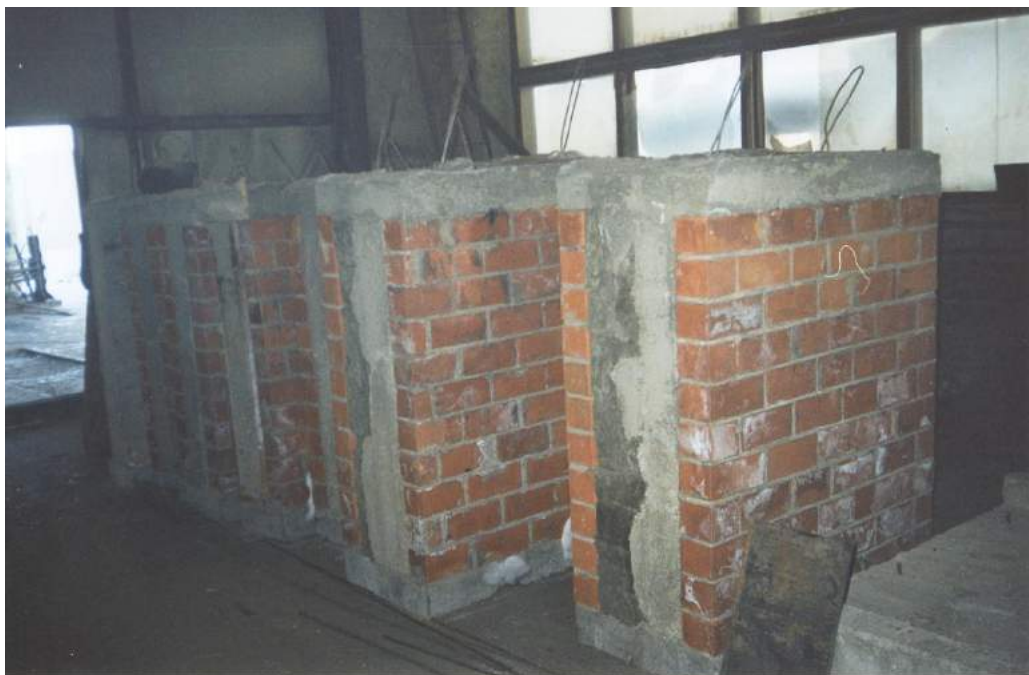
Рисунок 2.2 – Фрагменты трех- и четырехслойных стен перед испытаниями
