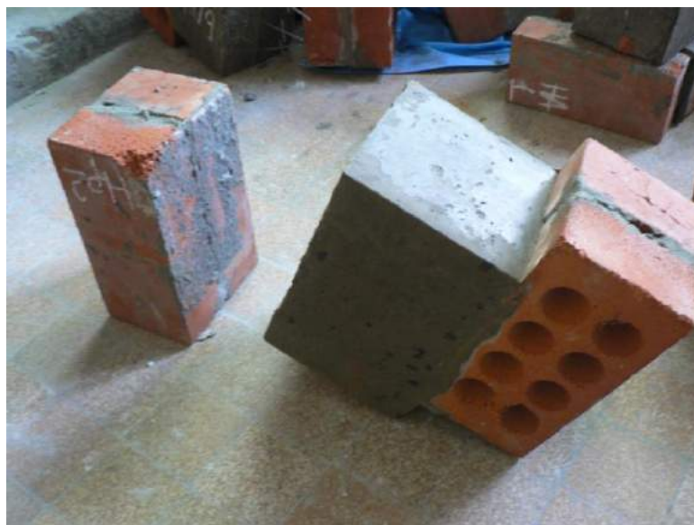
Рисунок 2.50 – Экспериментальный образец после испытаний
