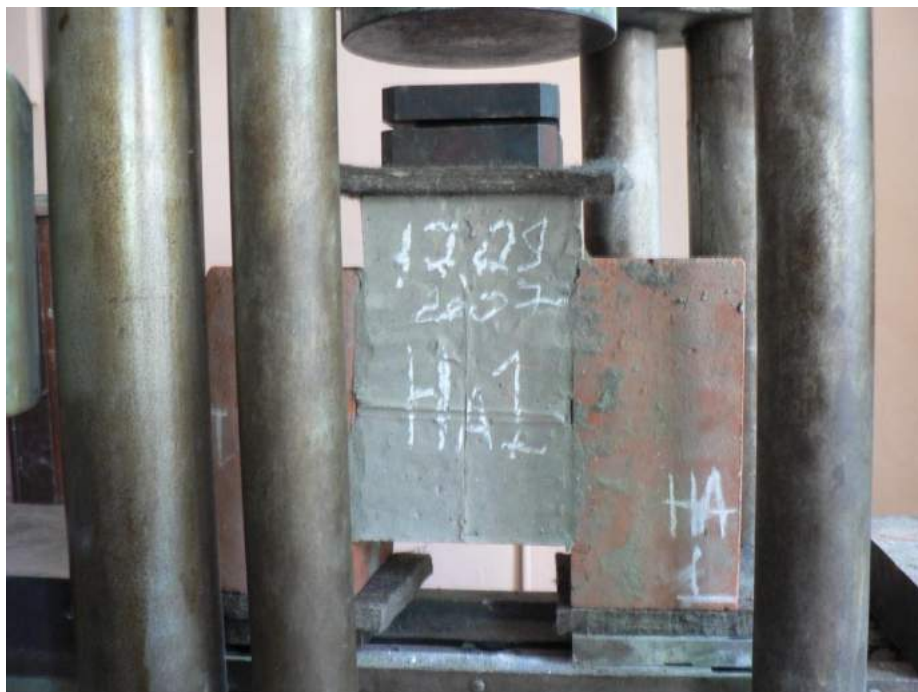
Рисунок 2.48 – Фрагмент для испытаний межслоевого касательного сцепления кирпичных и железобетонного слоев перед испытаниями.
