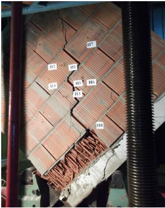
Рисунок 2.34 – Образец МС-2 после снятия нагрузки. N_p=185 т
